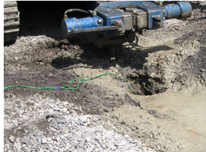
Eingebaute Temperaturfühler mit Datenlogger verbunden
