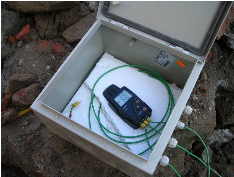
Datenlogger Fa. TESTO, Anschluss von vier Temperaturfühlern möglich
